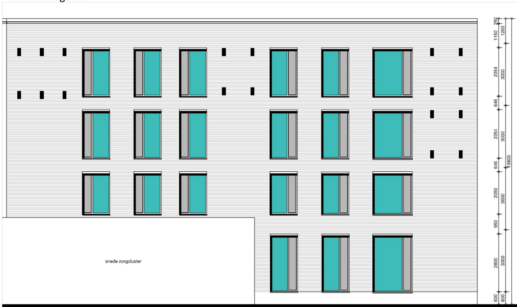
Figuur 7. Locaties open stootvoegen Gebouw A Zuidgevel
