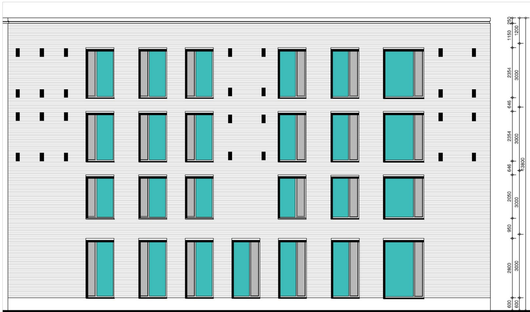
Figuur 8. Locaties open stootvoegen Gebouw A Noordgevel
