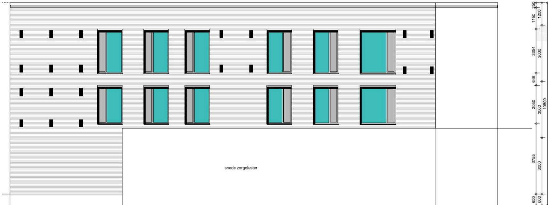
Figuur 11. Locaties open stootvoegen Gebouw C Zuidgevel
