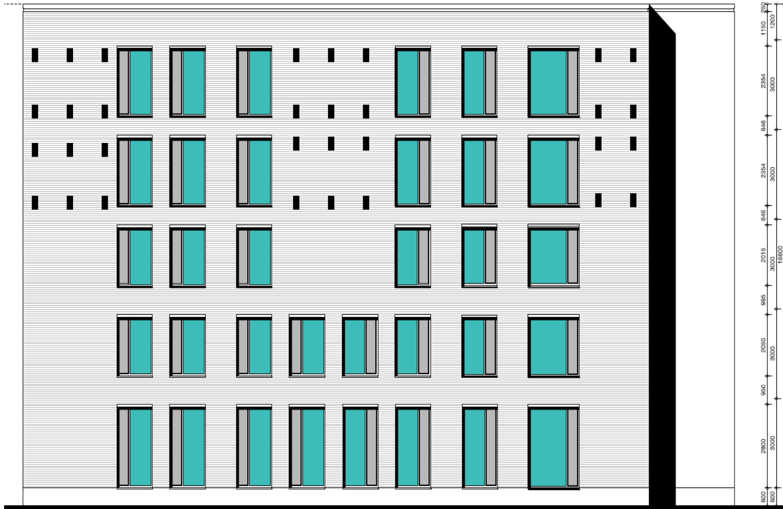
Figuur 10. Locaties open stootvoegen Gebouw B Noordgevel
