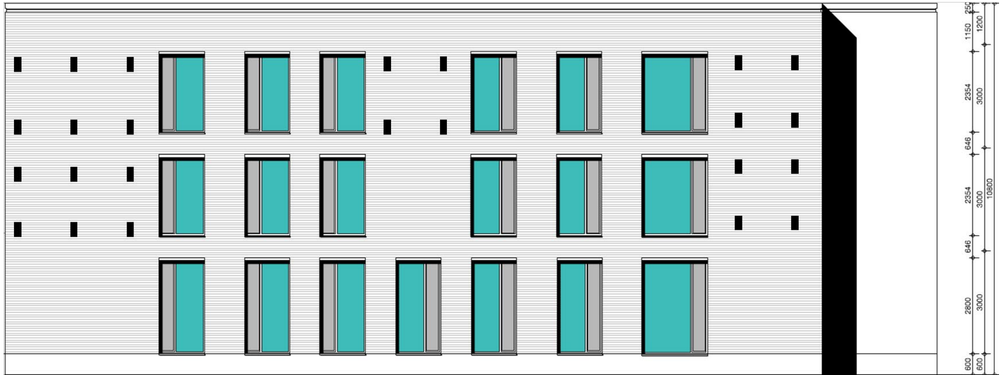
Figuur 12. Locaties open stootvoegen Gebouw C Noordgevel
