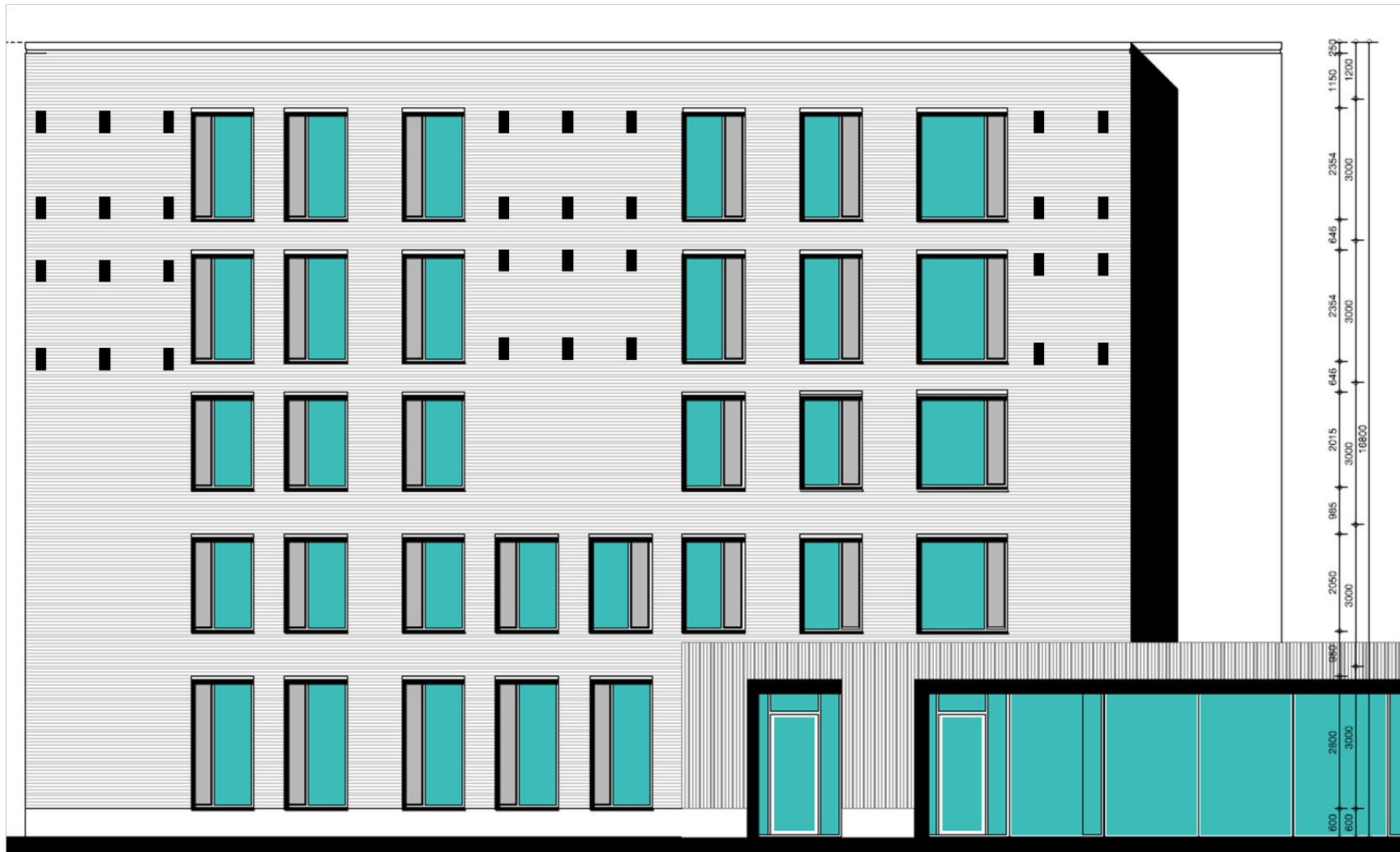
Figuur 9. Locaties open stootvoegen Gebouw B Zuidgevel
