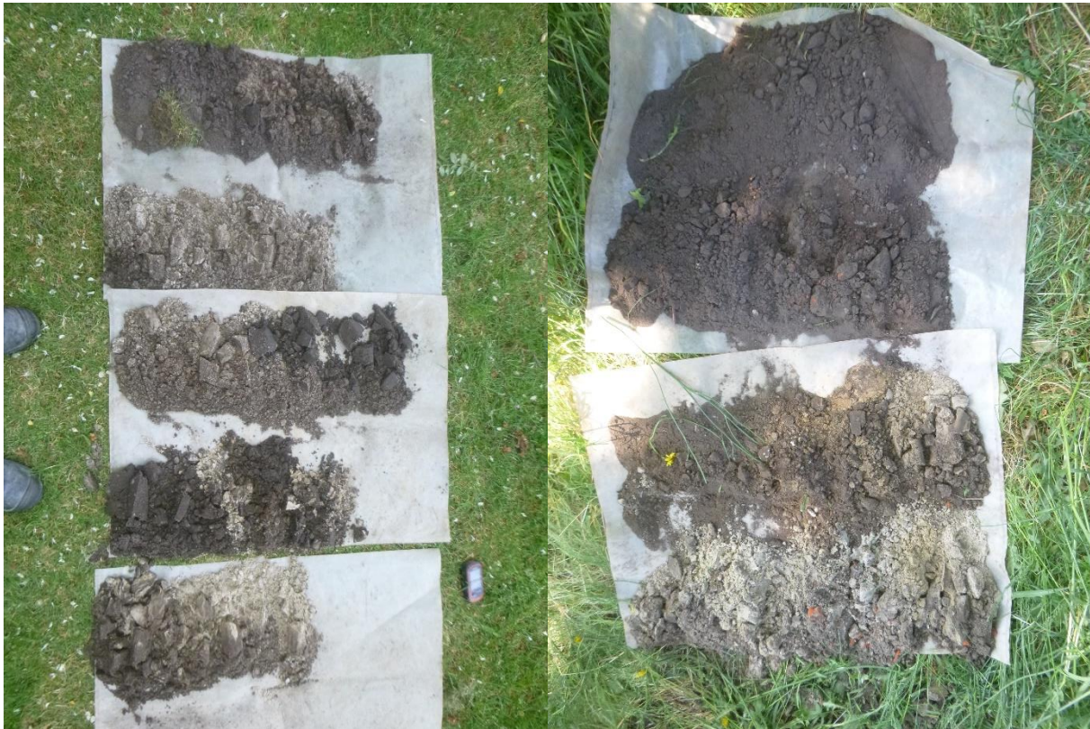
Fig. 3.1. Uden-Piusplein. Boorprofiel boring 2, 0-240 cm onder maaiveld. De leesrichting van linksboven naar rechtsonder (d.d. 06-06-2023).
