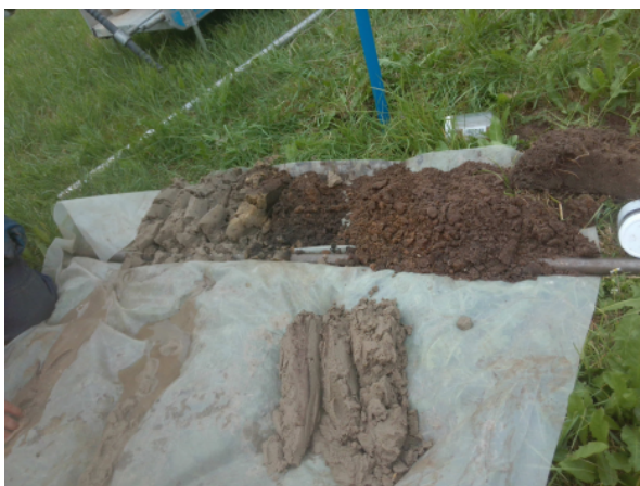
Fotonummer: 1 Omschrijving: boring 103
