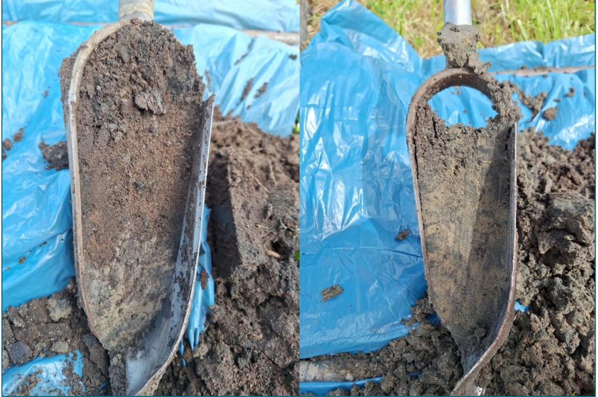
Afbeelding 5. Boring 4. Links: de grens tussen het veen en het dekzand met de vezels in het veen zichtbaar in de boorkop. Rechts: De humeuze vlekken in het dekzand in de boorkop.
