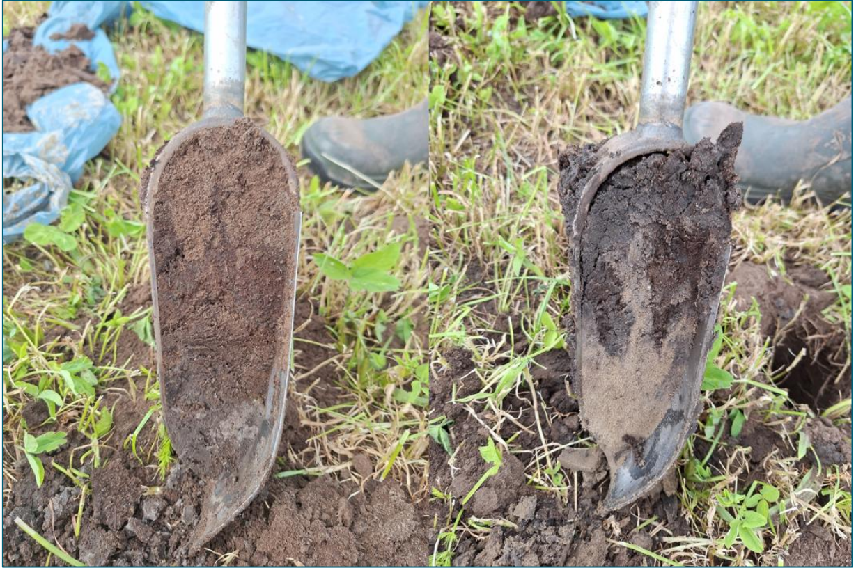
Afbeelding 4. Boring 3, links: de overgang tussen het veen en de kleilaag. Rechts: de overgang tussen de kleilaag en het dekzand.
