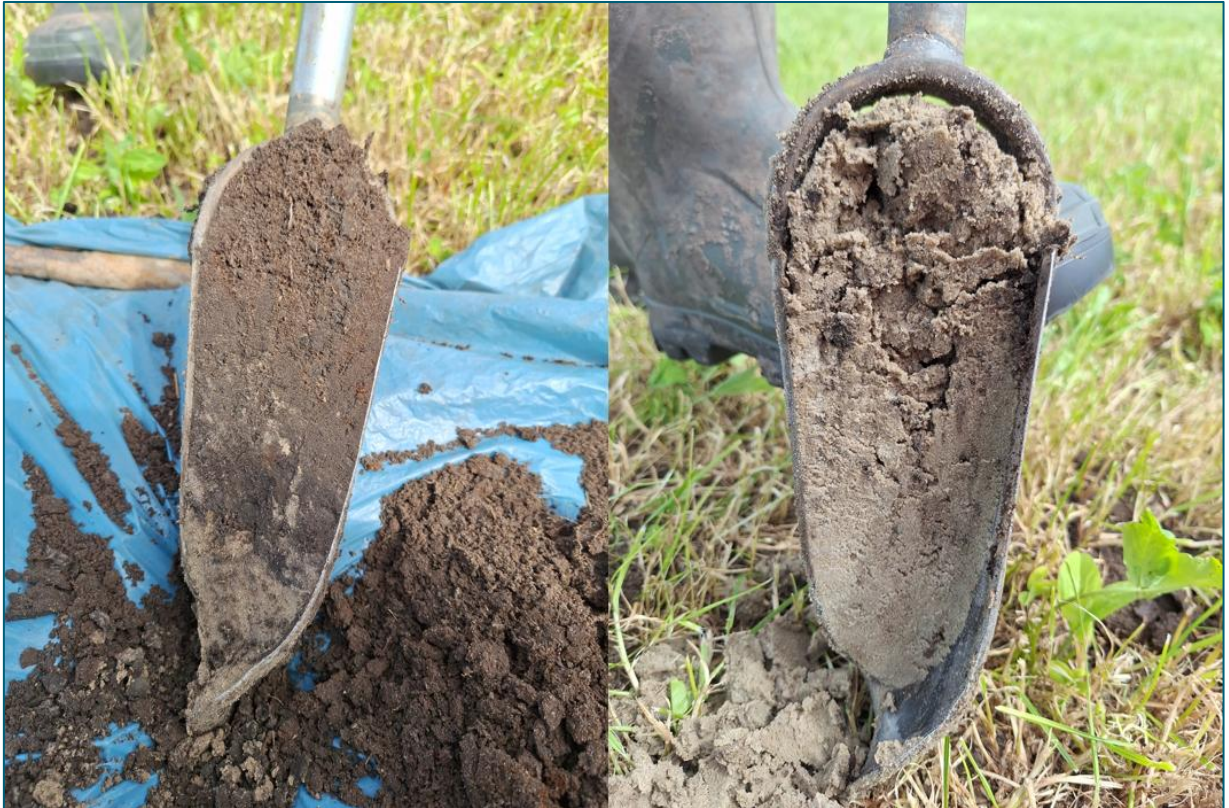
Afbeelding 6. Boring 6. Links: het zeer dunne veenbandje tussen de bouwvoor en het dekzand in de boorkop. Rechts: Het moedermateriaal met de concentraties lichtgrijswitte zandbrokjes.
