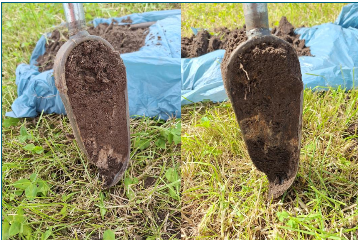
Afbeelding 3. Links: het lichte bandje tussen de bouwvoor en het veen in boring 1. Rechts: hetzelfde bandje in boring 5.
