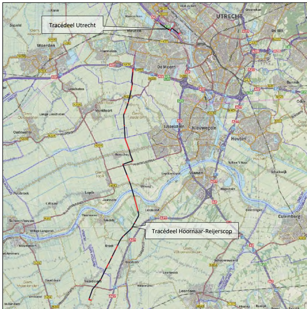
Figuur 1.1: topografische ligging tracé met in zwart de HDD's en in rood de veldstrekkingen (bron ondergrond: opentopo)
