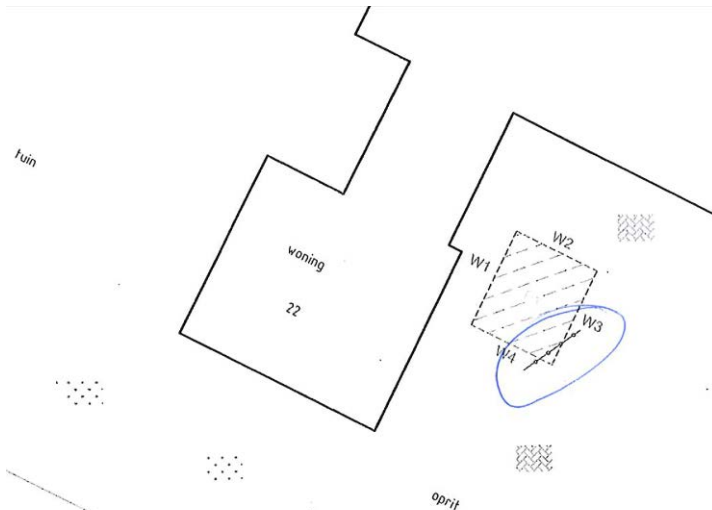
Figuur 8: Ontgravingsput HBO-tank met lokatie asbestvondst.
