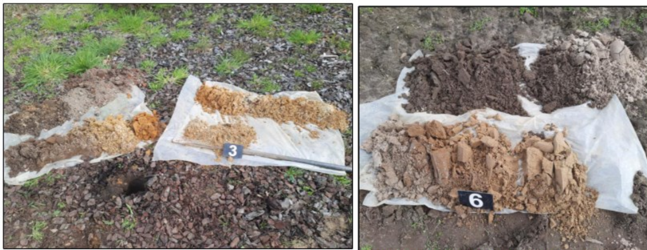
Afbeelding 7: Foto profielboringen I03 en I06, uitgelegd per halve meter vanaf maaiveld (linksboven) tot einddiepte (rechtsonder).
