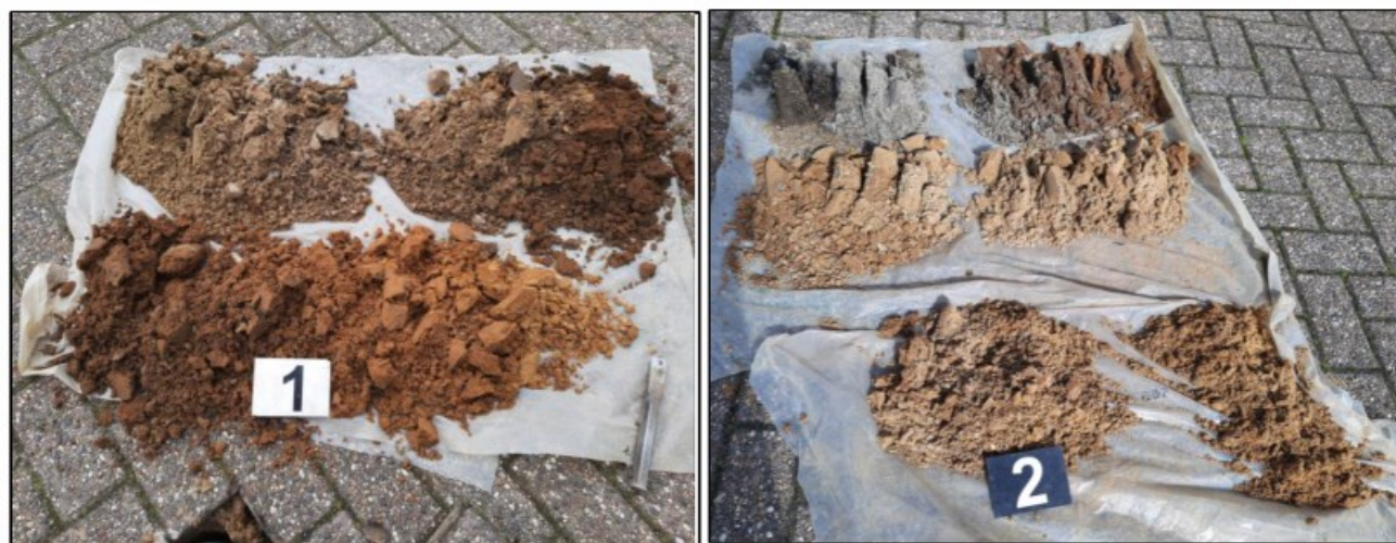
Afbeelding 6: Foto profielboring A/1 en B/2 uitgelegd per halve meter vanaf maaiveld (linksboven) tot einddiepte (rechtsonder).
