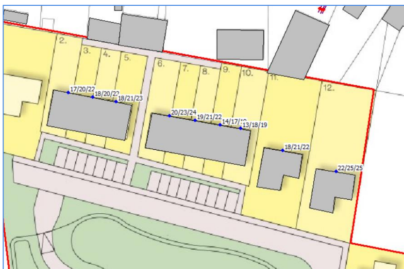
Afbeelding 10 Berekend L_{A,r,LT} (etmaalwaarden) Bong 75
