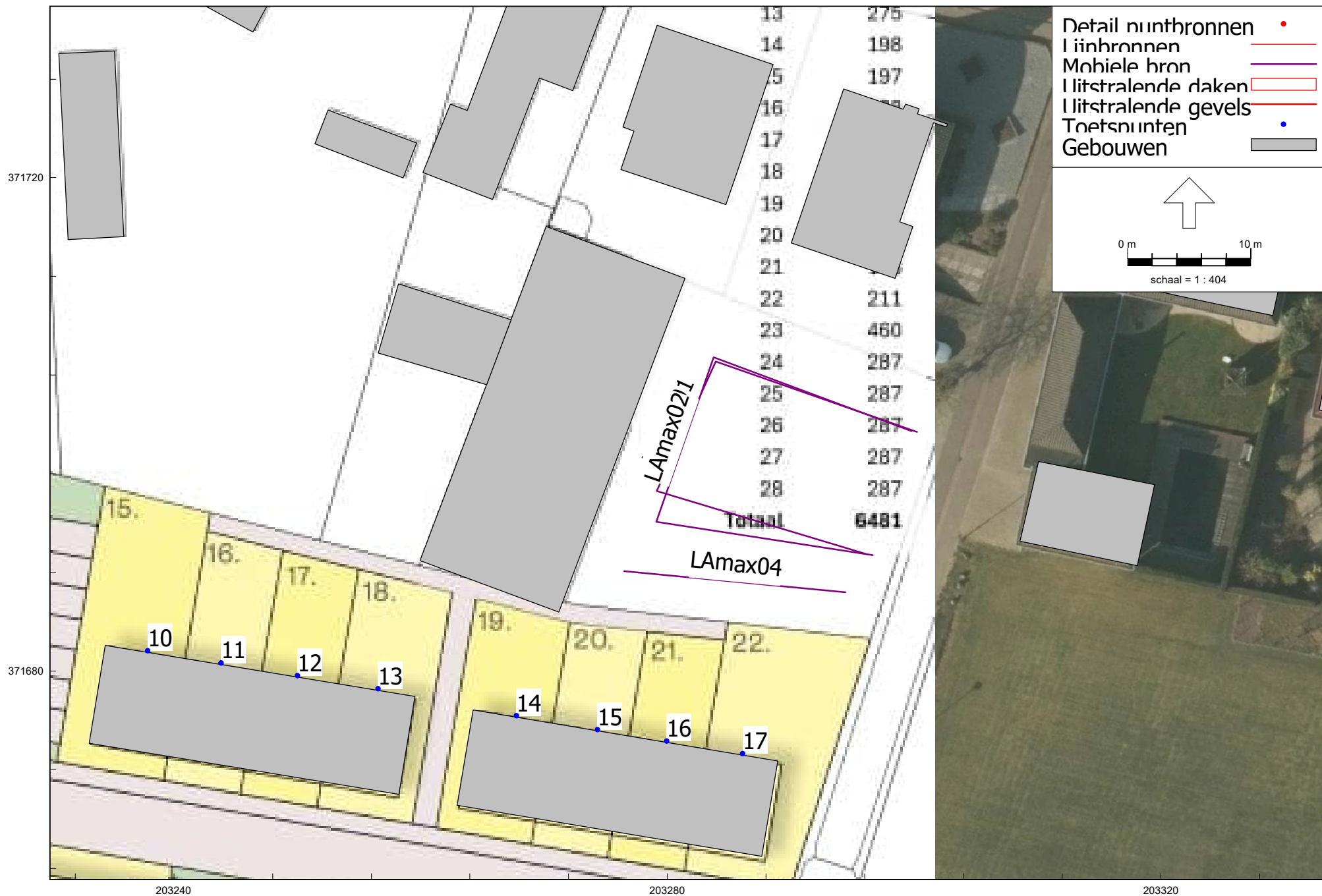
Figuur 2: Grafische weergave rekenmodel - LAmax Bergweg 4
