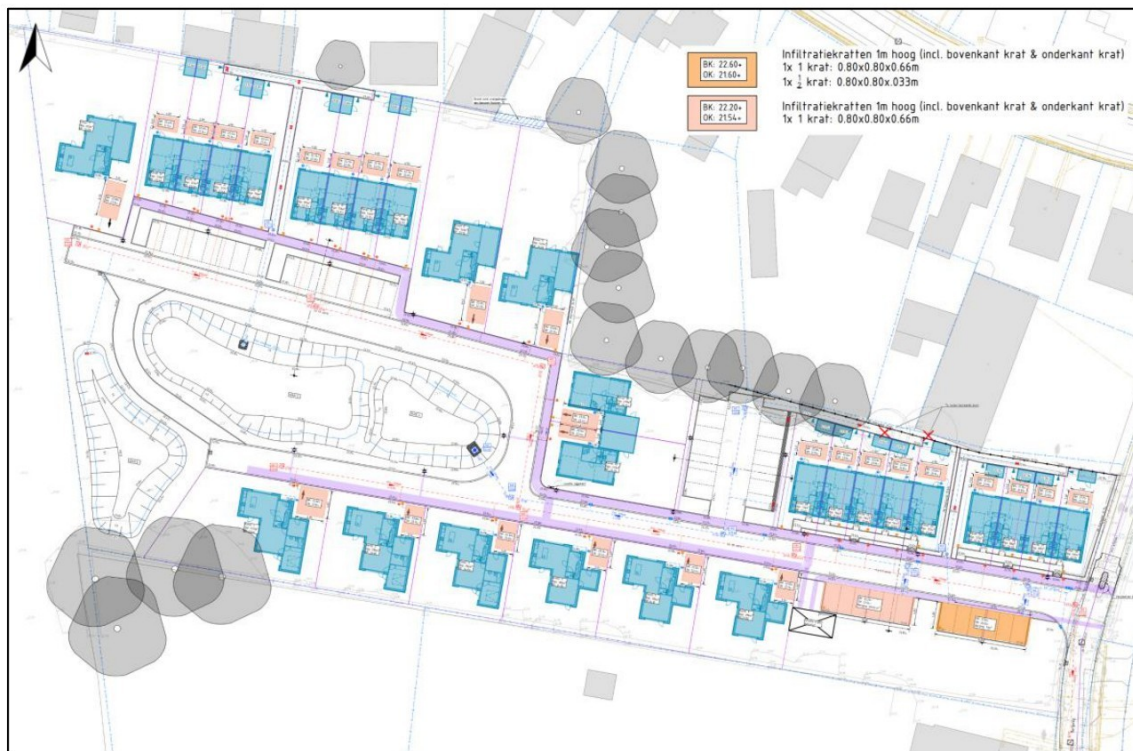
Afbeelding 15 Stedenbouwkundig ontwerp ondergrondse infra met in het oosten infiltratiekratten onder de parkeerplaatsen.
