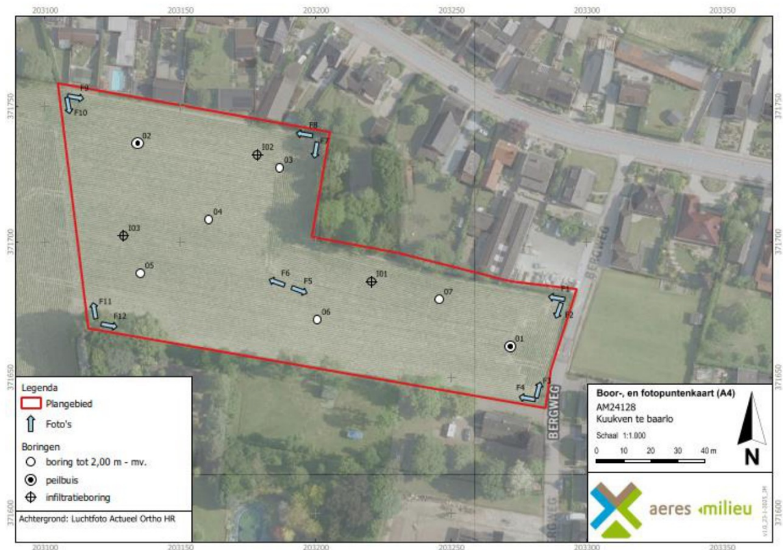
Afbeelding 12 Locaties infiltratiemetingen. Bron: Aeres Milieu, AM 2 4128.
