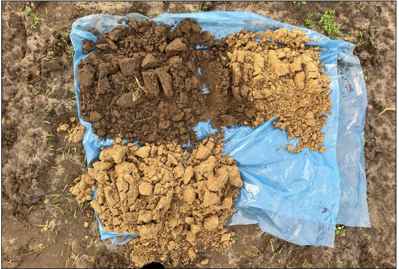
Afbeelding 4: Foto infiltratieboring I02 uitgelegd per halve meter vanaf maaiveld (linksboven) tot einddiepte van 1,5m (rechtsonder)
