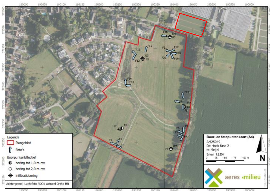
Afbeelding 11 Locaties boringen en infiltratiemetingen 2
