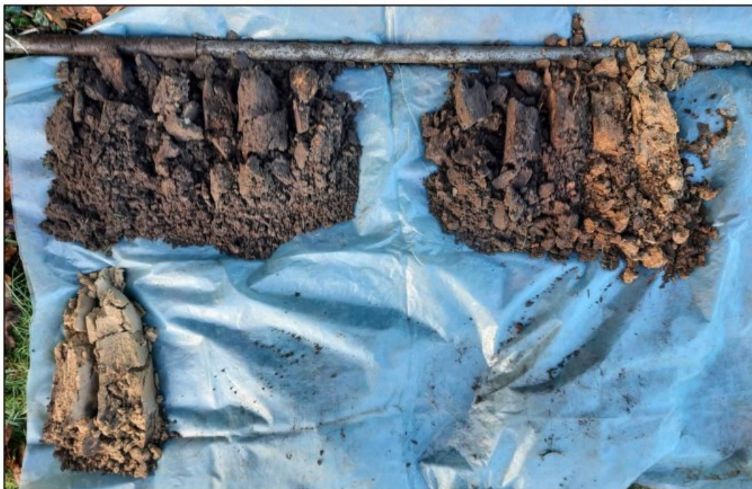
Figuur 8. Foto van boring 6. De leesrichting is van linksboven naar rechtsonder (0 – 120 centimeter) (Foto: 8 januari 2025).
