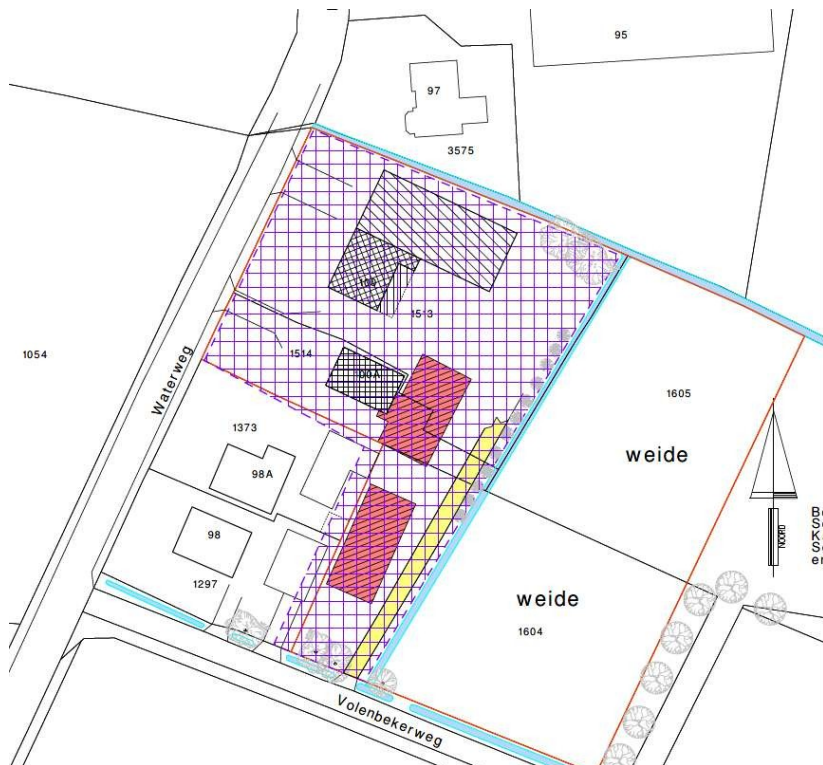
Bestaand en te slopen
