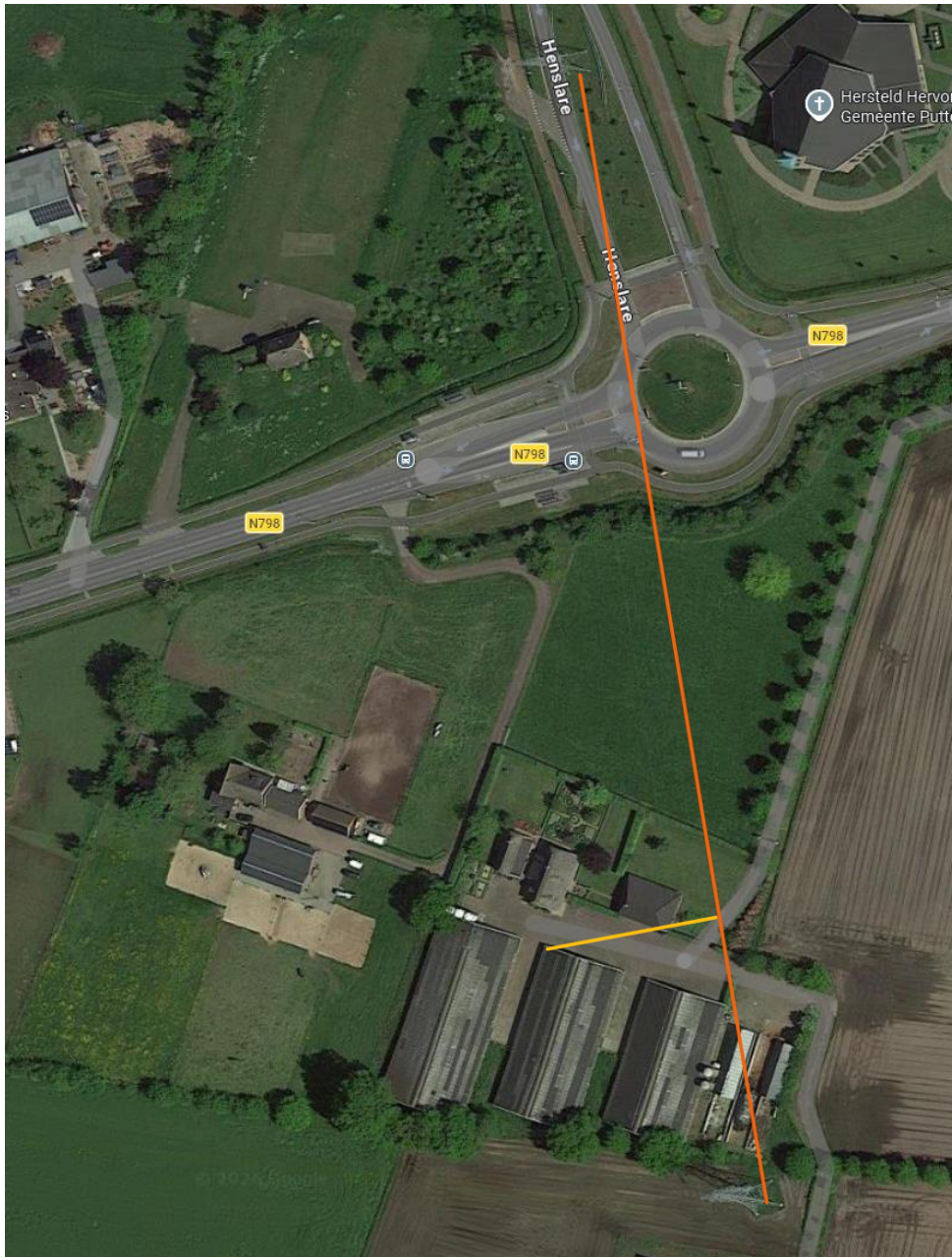
Figuur 5-3. Impressie van de situatie op Google Maps inclusief een indicatie van de afstand tot aan de hartlijn van de 150Kv lijn. De ingetekende geel/oranje lijn is een indicatie van de afstand tot de locatie. Deze blijkt ongeveer 40 meter te zijn.
