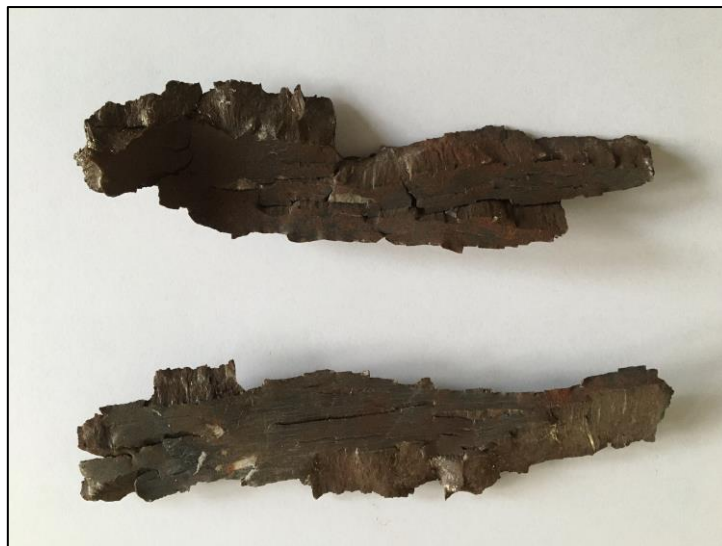
Afbeelding 43: Scherven na detonatie van een met springstof gevuld OO.
