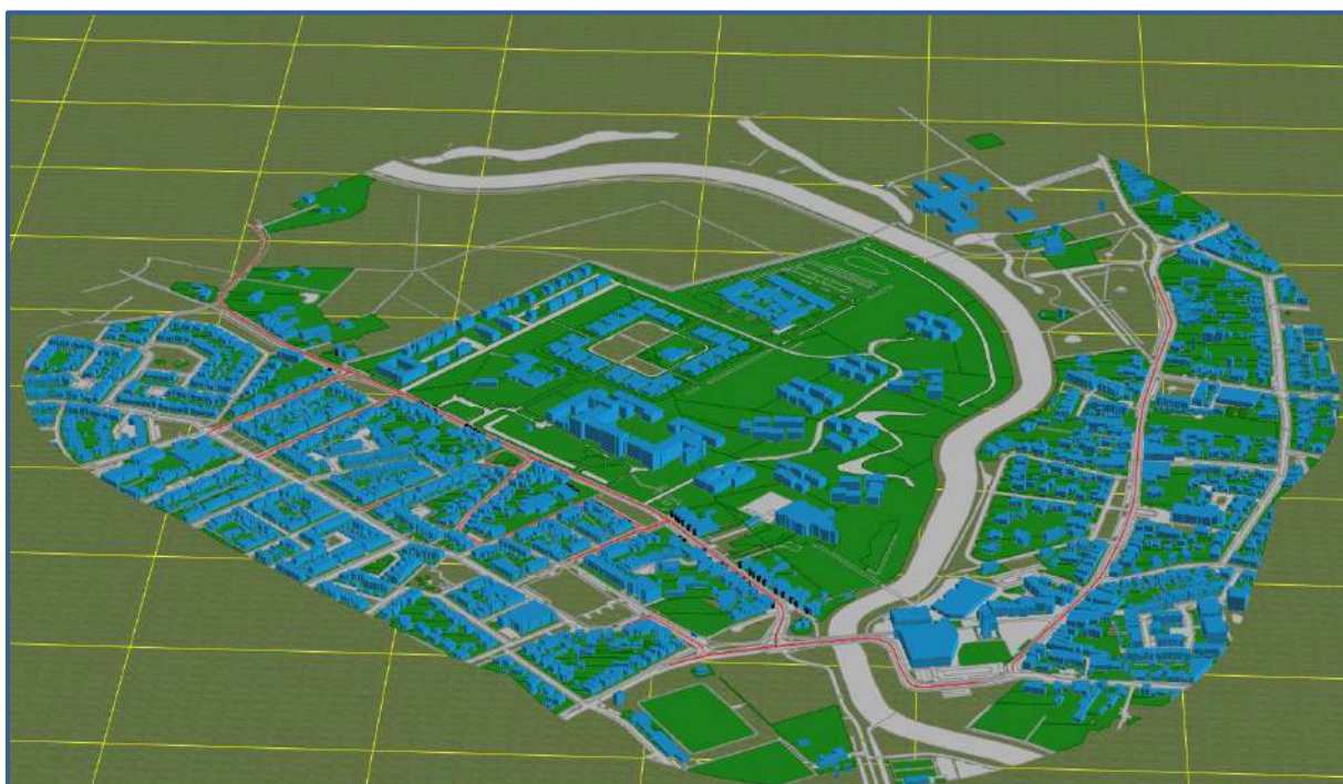
Afbeelding 7. Rekenmodel wegverkeerslawaai op bestaande woningen, 3d-weergave
