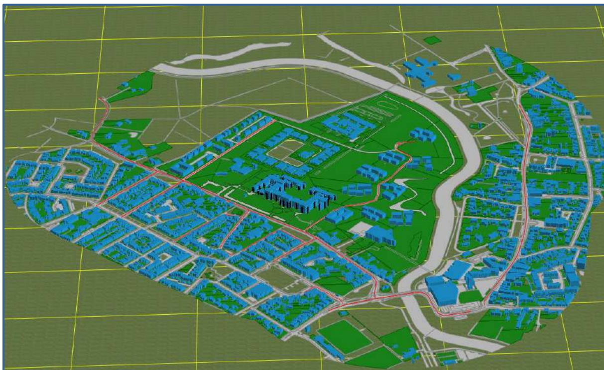
Afbeelding 6. Rekenmodel wegverkeerslawaai op plan fase 1, 3d-weergave
