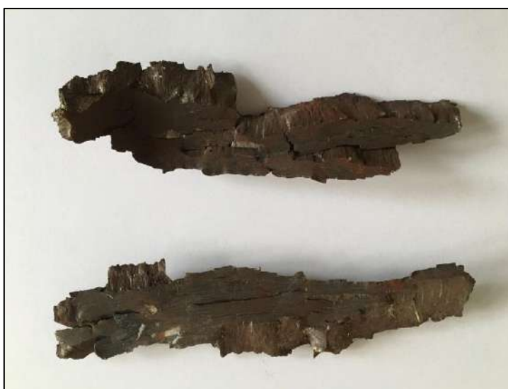
Afbeelding 43: Scherven na detonatie van een met springstof gevuld OO.
