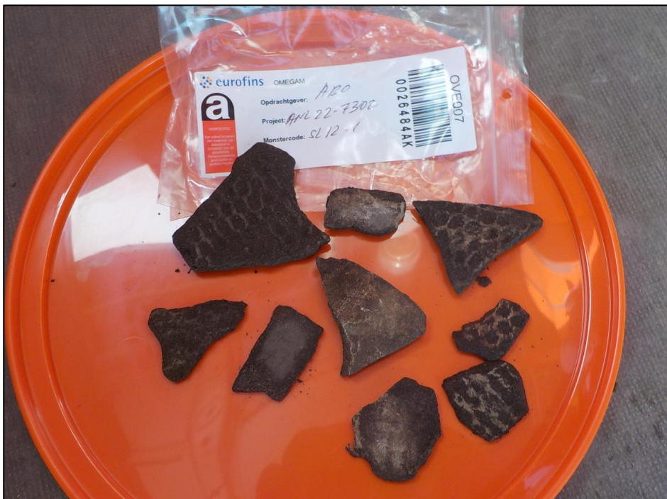
Foto 11: Asbesthoudend plaatmateriaal uit asbestinspectiesleuf SL11
