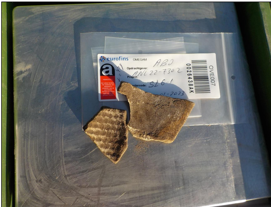
Foto 9: Asbesthoudend plaatmateriaal uit asbestinspectiesleuf SL6
