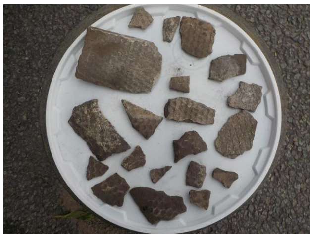
Foto 6: asbest verzameld van het maaiveld
