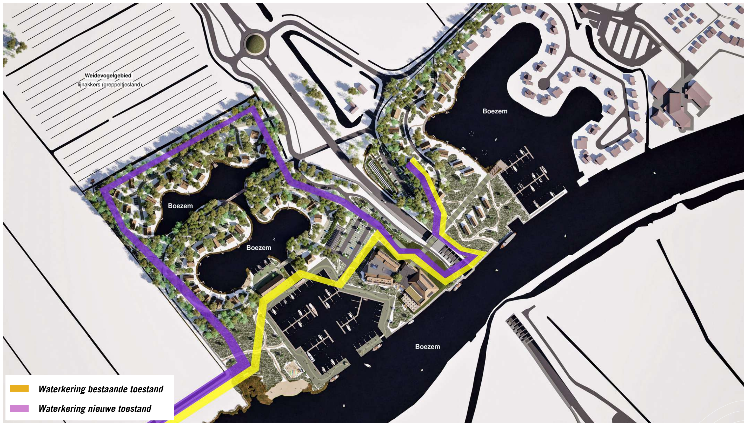
Figuur 46 Waterkering bestaande en nieuwe situatie
