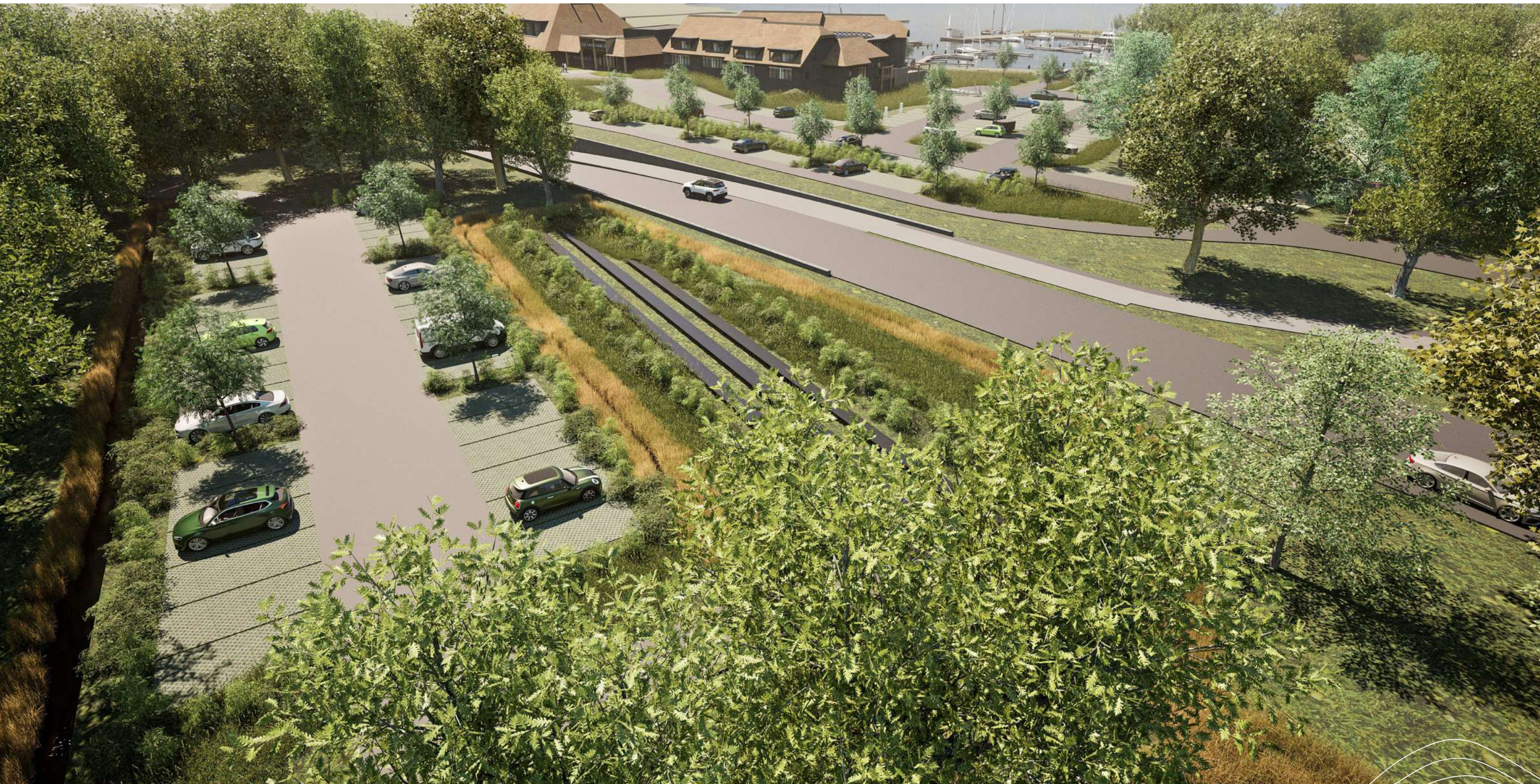
Figuur 80 Vogelvluichtperspectief van de parkeerkoffers met halfverharding (grasbetontegels)
