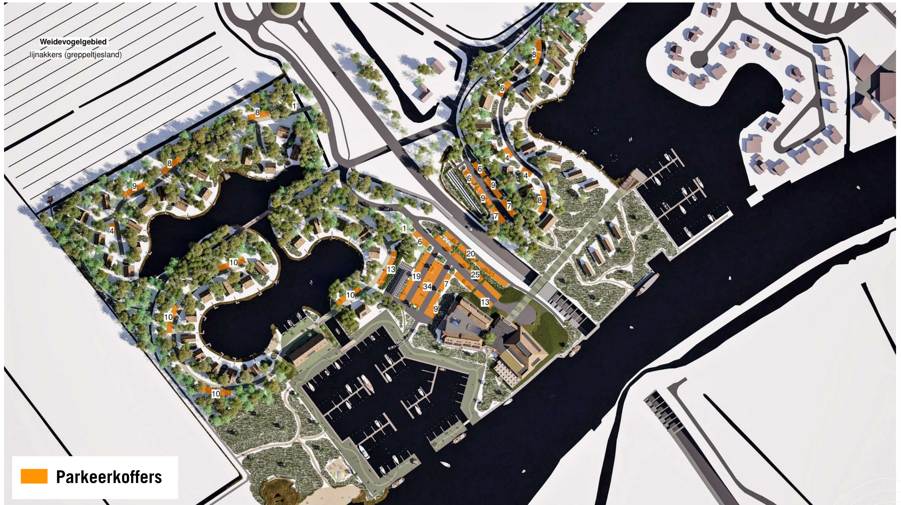
Figuur 53 Parkeerkoffers (omsloten door begroeiing en voorzien van doorgroeitegels / 292 parkeerplekken in totaal)
