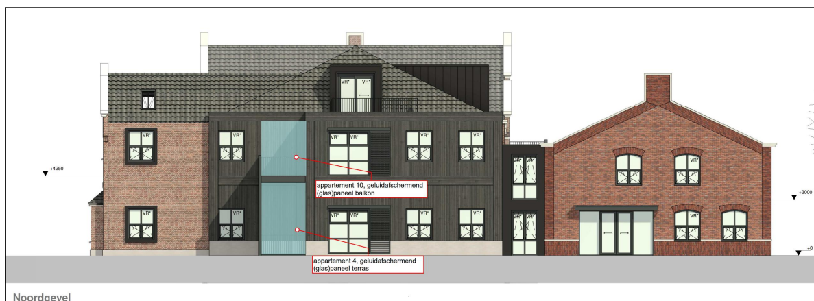
Afbeelding 5: geluidafschermend (glas)paneel terras/balkon
