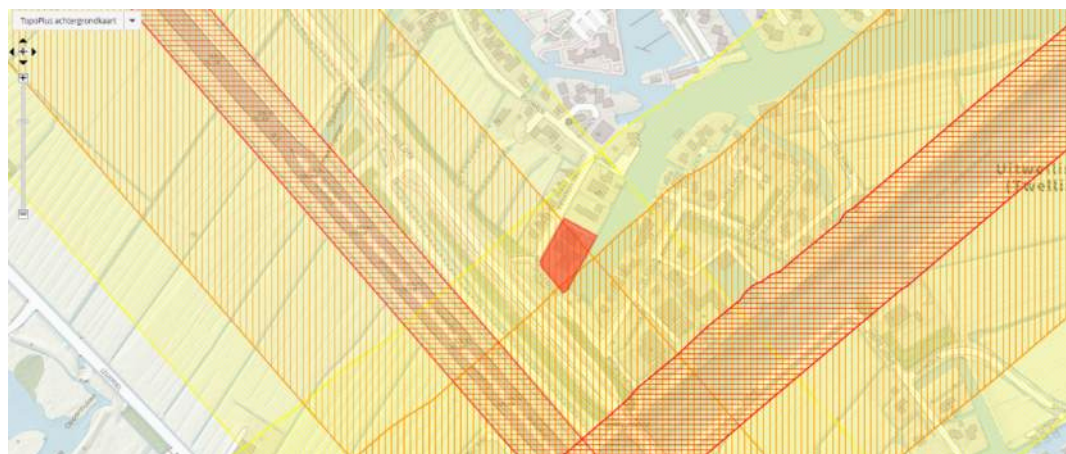
Figuur 3. Brandaandachtsgebied (rood gekleurd), explosieaandachtsgebieden (oranje gekleurd) en gifwolkaandachtsgebied (geel gekleurd) van zowel de A7 (links in figuur) als het PM kanaal (rechts in figuur).
