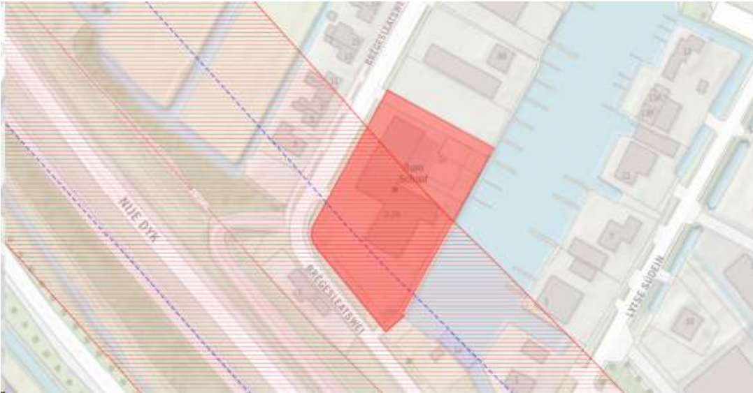
Figuur 4.4 Buisleiding (rode stippellijn), 100% Letaliteitszone (blauwe stippellijn), brandaandachtsgebied (gebied binnen de rode lijnen)
