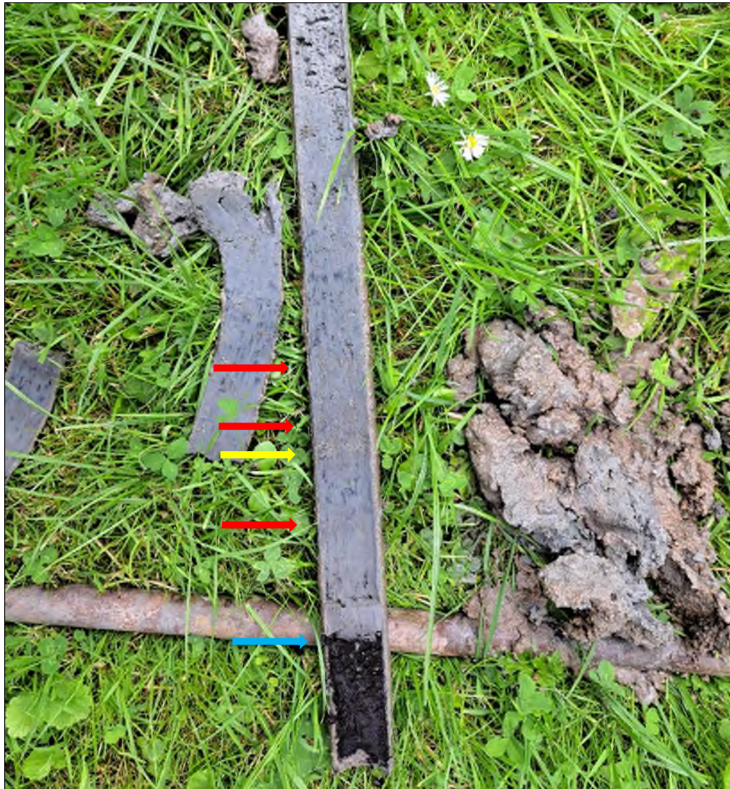
Afbeelding 12: Een deel van de gutsboring van boorpunt 3. De grijs-blauwe zeeklei met zand- (gele pijl) en detritis (rode pijl) is afgezet op het veen (blauwe pijl scherpe overgang) . Foto: Antea Group, 2023.
