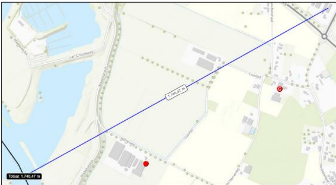
Afbeelding 21: Uitsnede externe risicokaart met afstand tot de Maascorridor (bron: quickscan externe veiligheid, Lycens)
