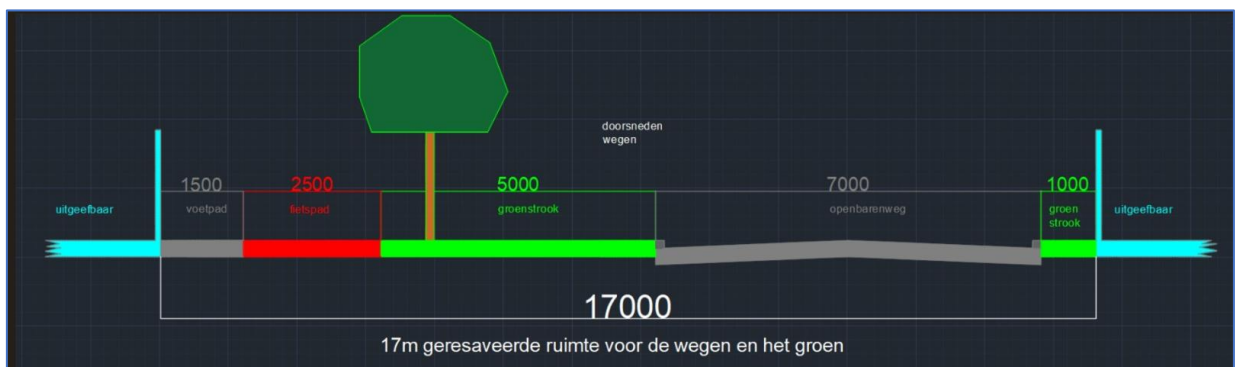
Figuur 10 b: Principe profiel openbaar gebied (17 m)
