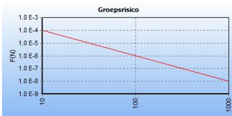
5.14 Figuur 5.14 FN curve voor 8958_leiding-N-575-61-deel-1 van N.V. Nederlandse Gasunie voor de kilometer tussen stationing 0.00 en stationing 60.00
