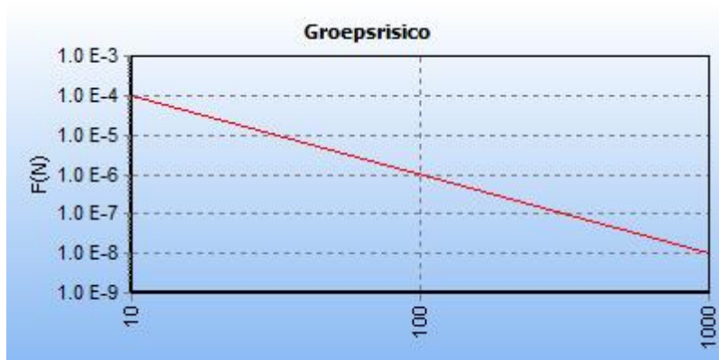
5.17 Figuur 5.17 FN curve voor 8958_leiding-N-576-70-deel-1 van N.V. Nederlandse Gasunie voor de kilometer tussen stationing 0.00 en stationing 1000.00
