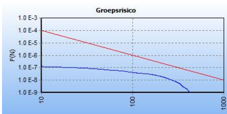
5.5 Figuur 5.5 FN curve voor 8958_leiding-A-533-deel-1 van N.V. Nederlandse Gasunie voor de kilometer tussen stationing 4240.00 en stationing 5240.00
