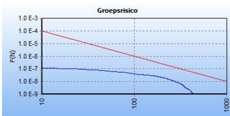
5.5 Figuur 5.5 FN curve voor 8958_leiding-A-533-deel-1 van N.V. Nederlandse Gasunie voor de kilometer tussen stationing 4260.00 en stationing 5260.00
