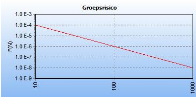
5.2 Figuur 5.2 FN curve voor 8958_leiding-A-507-deel-1 van N.V. Nederlandse Gasunie voor de kilometer tussen stationing 810.00 en stationing 1810.00
