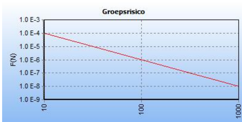
5.8 Figuur 5.8 FN curve voor 8958_leiding-A-555-deel-1 van N.V. Nederlandse Gasunie voor de kilometer tussen stationing 0.00 en stationing 1000.00
