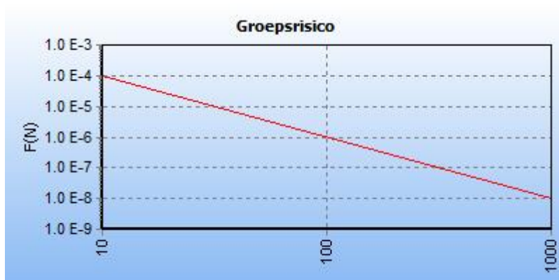
5.20 Figuur 5.20 FN curve voor 8958_leiding-N-576-01-deel-1 van N.V. Nederlandse Gasunie voor de kilometer tussen stationing 0.00 en stationing 1000.00
