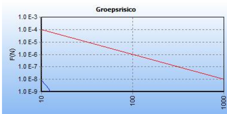
5.19 Figuur 5.19 FN curve voor 8958_leiding-N-576-75-deel-1 van N.V. Nederlandse Gasunie voor de kilometer tussen stationing 0.00 en stationing 0.00
