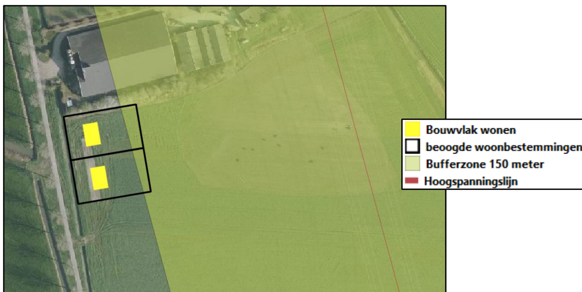
Afbeelding 25: Afstand bouwvlak wonen tot hoogspanningslijn
