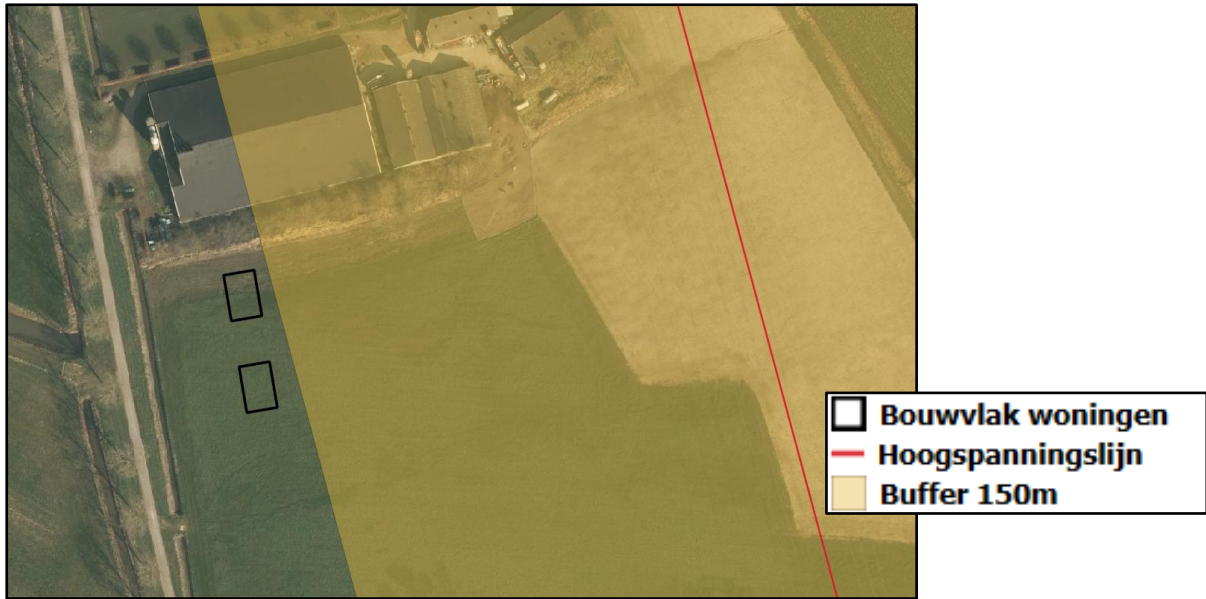
Afbeelding 26: Afstand bouwvlak wonen tot hoogspanningslijn
