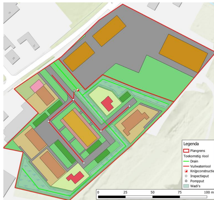
Figuur 6-1: Schetsontwerp ligging riolering en waterbergende voorzieningen (vergroot in bijlage C)
