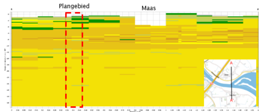
Figuur 3-3: Dwarsprofiel noord-zuid plangebied met meest waarschijnlijke lithoklasse (bron: DINOloket, model GeoTOP, 2025). Legenda weergegeven in figuur 3-2.
