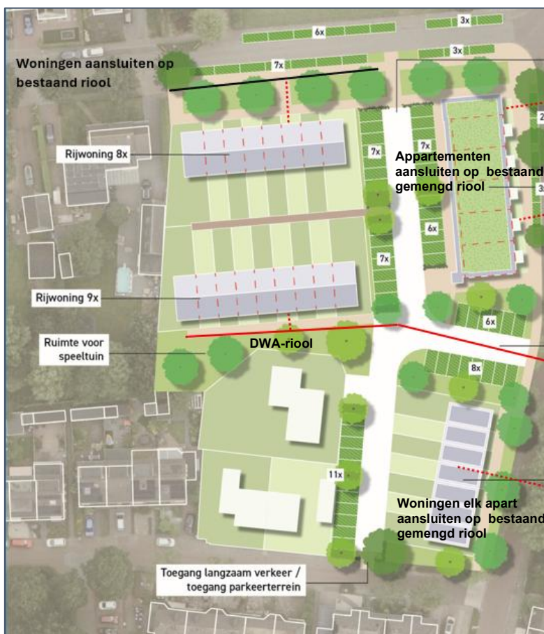
Figuur 9: principe oplossing dwa-riool
