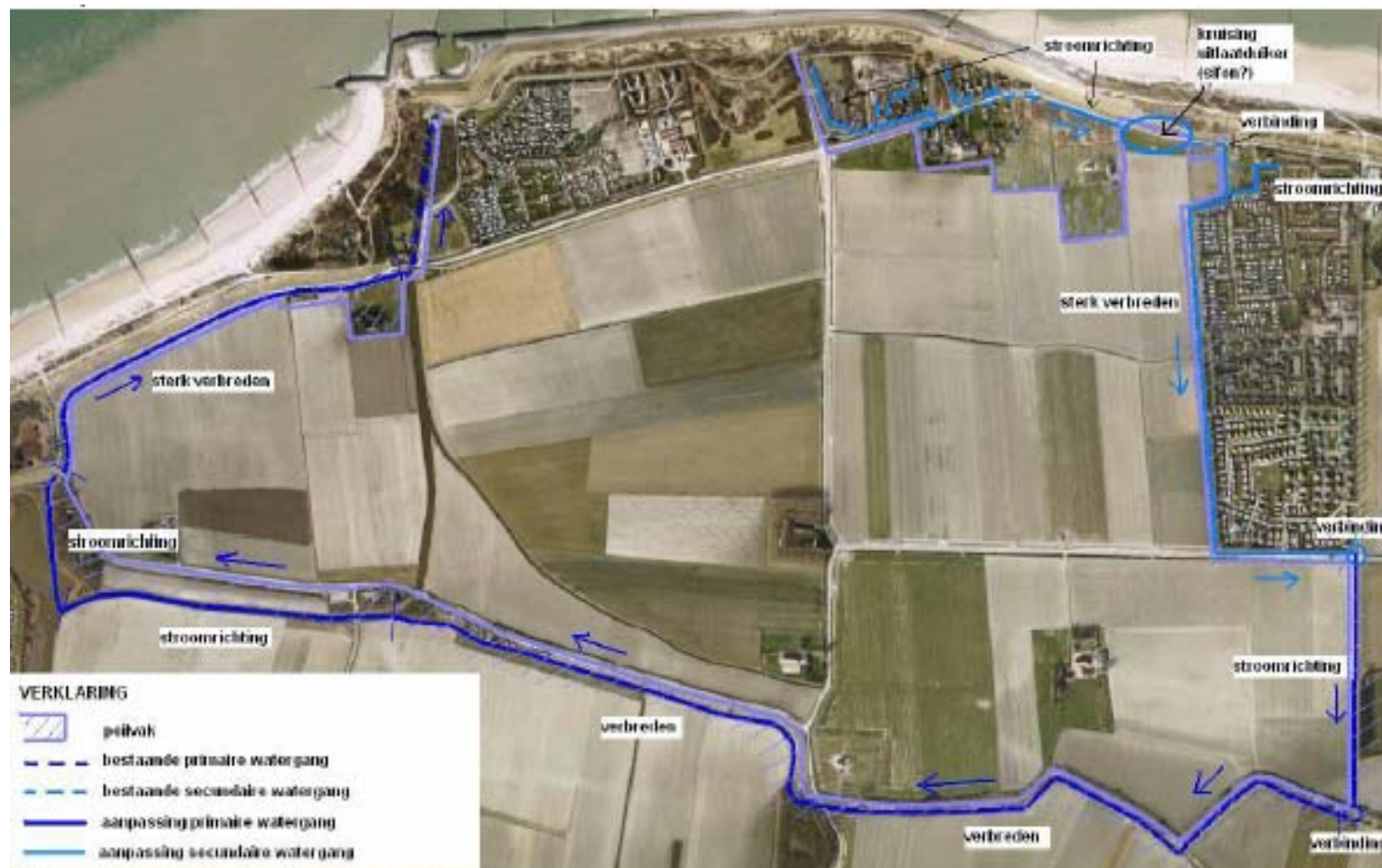
Figuur - b: Maatregelen aanpassing van de afwatering.
