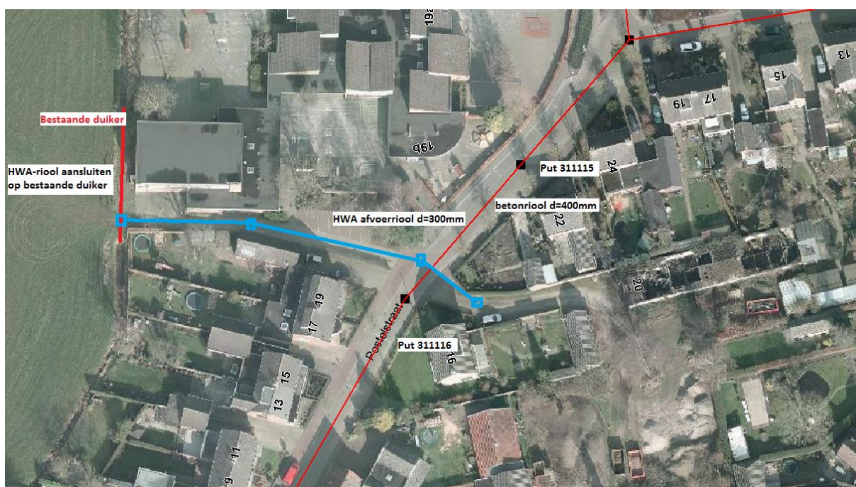
Figuur 4.1 Principiële uitwerking voorkeursvariant van de gemeente voor het inzamelen en verwerken van regenwater uit het plangebied (aangeleverd door de gemeente).
