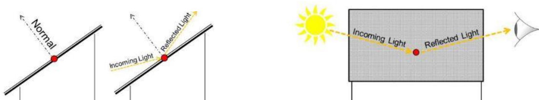
Figuur 5. Bij reflectie van zonlicht is de inkomende hoek altijd gelijk aan de uitgaande hoek, ten opzichte van een loodrechte lijn op het oppervlak van het paneel
