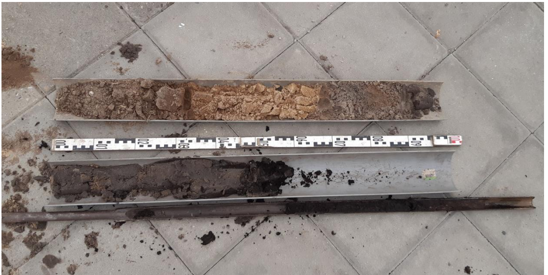
Afbeelding 12: Foto van het boorprofiel van boring 3 met v.l.n.r. en van boven naar onder de subrecente gevlekte ophoging, de gele laag 'stuifzand', de lichtgrijze en donkergrijze overstoven oude bodem en het donkerbruine veen (restgeulvulling) overgaand in grijs matig fijn zand.
