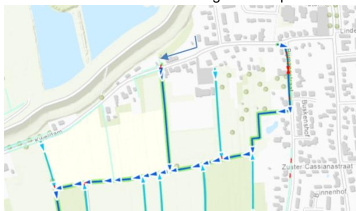
Figuur 13: Huidige watergang en duiker naar tertiaire watergang uit de legger
