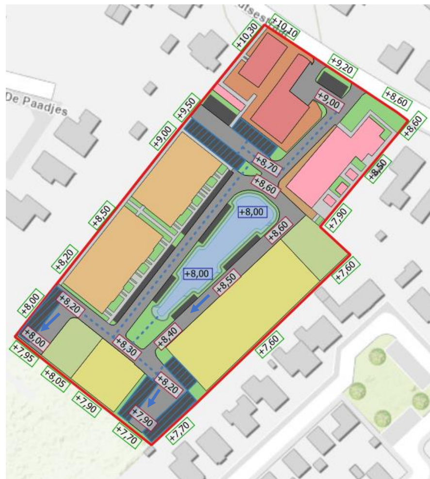
Figuur 4-2: eerste opzet hoogte plan, groen omrand bestaande hoogtes op basis van AHN4, rodomrand voorstel wegpeil en blauw omrand voorstel bodemhoogte infiltratieveld.
