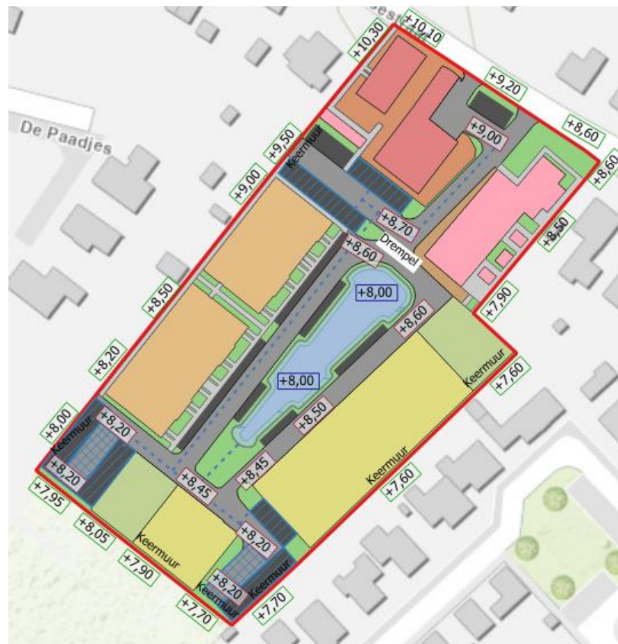
Figuur 6-4: eerste opzet hoogte plan, groen omrand bestaande hoogtes op basis van AHN4, roodomrand voorstel wegpeil en blauw omrand voorstel bodemhoogte infiltratieveld. Advieshoogte keermuur NAP +8,30 m.
