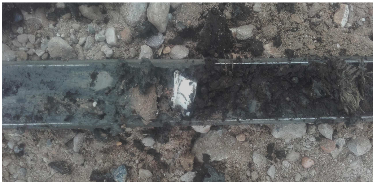
Figuur 20. Sediment in boring 3 met in de top van het veenpakket (3,8 m -Mv) een fragment industrieel wit aardewerk.
