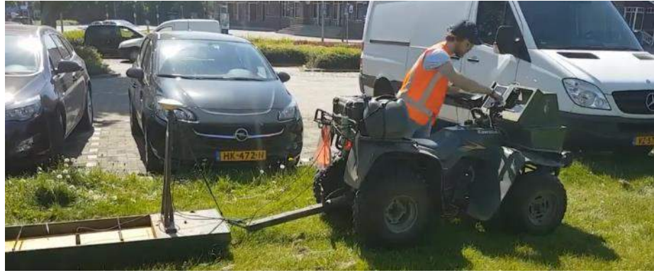
Figuur 9: Quad met frontaal gemonteerde gammaspectrometer en een secundaire ZONDe antenne (300 Mhz) op een slee op de veldwerklocatie te Kampen.
