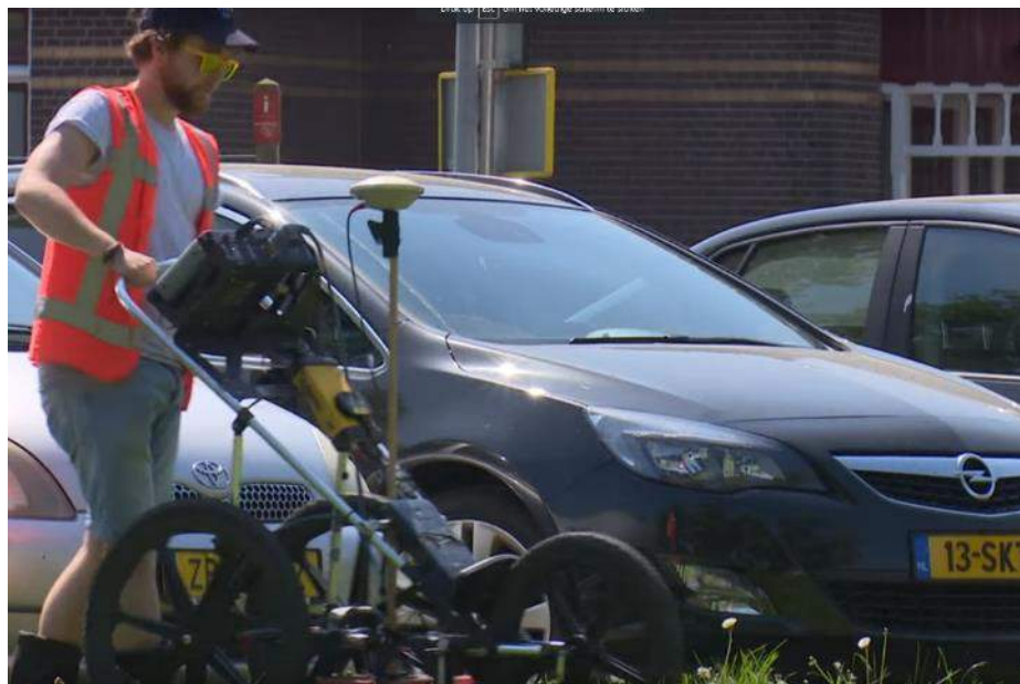
Figuur 10: GSSI met een 400 Mhz antenne en RTK-GPS positionering gemonteerd op een kinderbuggy op de veldwerklocatie te Kampen.
