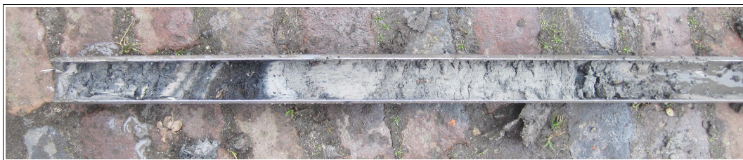
Figuur 7: Kampen, IJsseldijk 26: monster boring 3 van 360 tot 400 centimeter. In de guts zit slappe klei met daarin lagen of brokken zand en klei. De afzetting is waarschijnlijk gevormd door het storten van grond.
