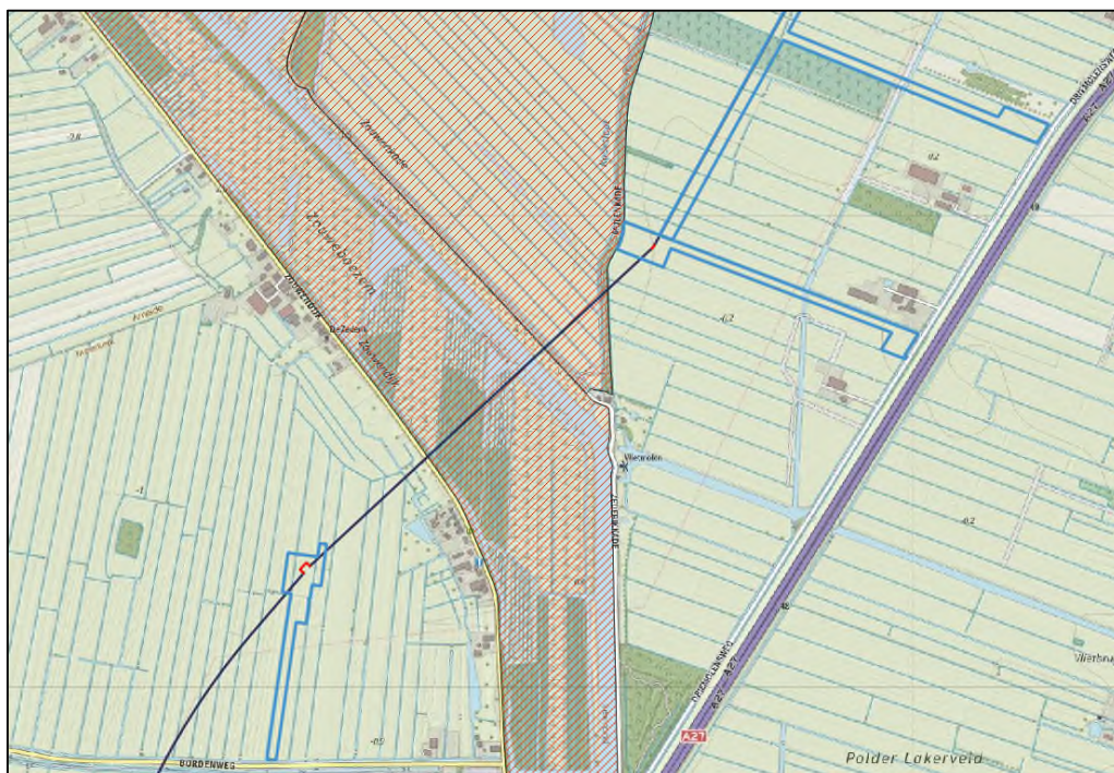
Figuur 2.1: kruising van de Natura 2000-gebied Zouweboezem met in zwart de aan te leggen leiding in HDD's, in rood de aan te leggen leiding in open ontgraving en in blauw de werkstrook, rijroutes en werkkerreinen. Bron achtergrond: opentopo.
