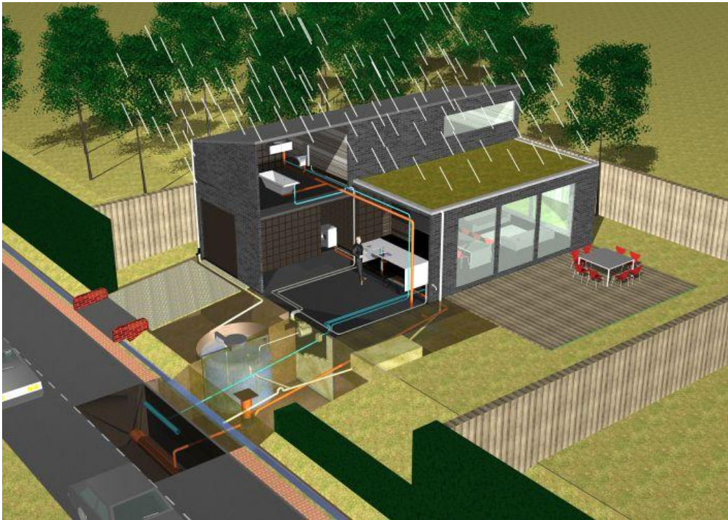
Afbeelding: schematische voorstelling afkoppeling, berging en infiltratie hemelwater (bron: www.vmm.be )
