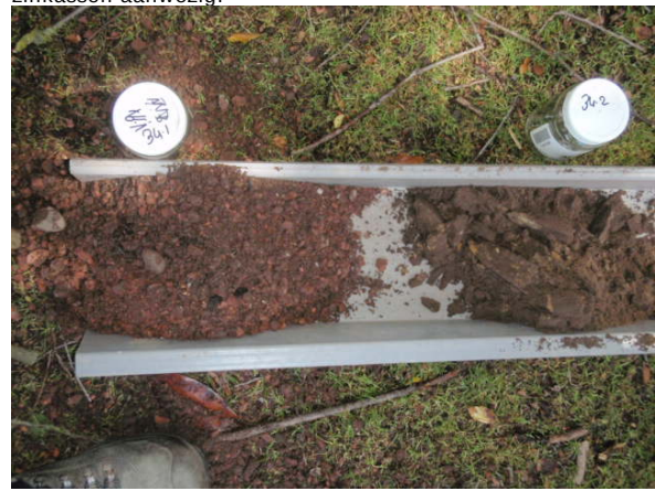
Foto 19: locatie 2, onder de splitverharding is geen laag met zinkassen aanwezig maar zand.
