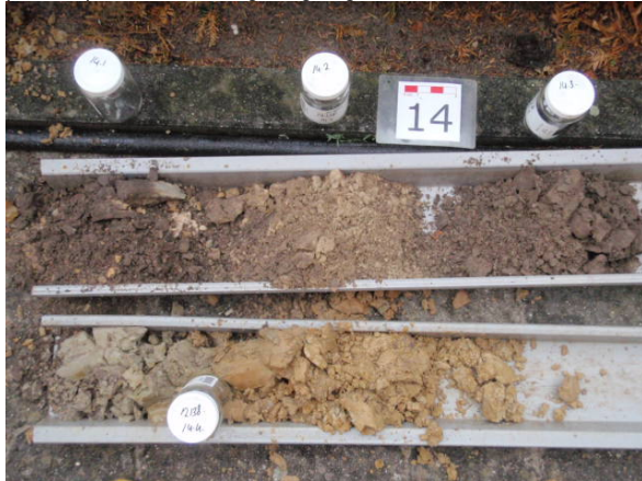
Foto 16: locatie 1, de bodemopbouw ter plaatse van voorkant gemeentehuis.
