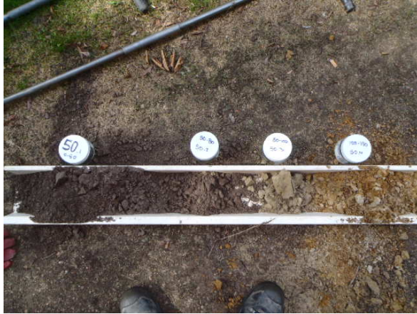
Foto 24: locatie 2, ter plaatse van overige boringen, waaronder boring 50, zijn geen zinkassen onder splitverharding aangetroffen.
