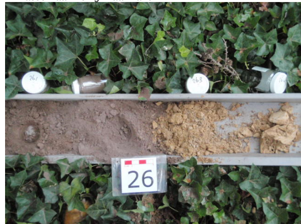
Foto 21: locatie 2, de bodemopbouw ter plaatse van sporthal.
