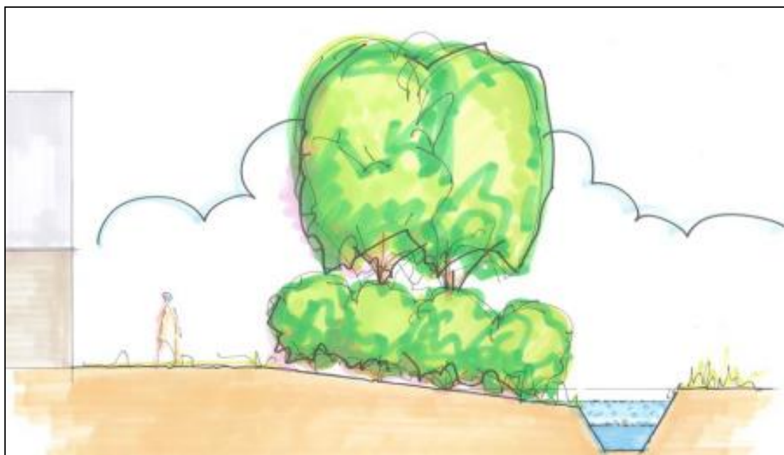
Afbeelding 13. Doorsnede singel met infiltratievoorziening
