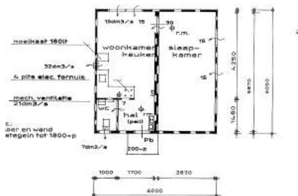
Figuur 9. Bouwtekening woonruimte 4
