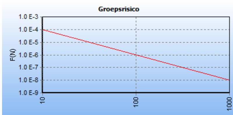
5.4 Figuur 5.4 FN curve voor 4263_leiding-Z-513-01-deel-1 van N.V. Nederlandse Gasunie voor de kilometer tussen stationing 3520.00 en stationing 4520.00
