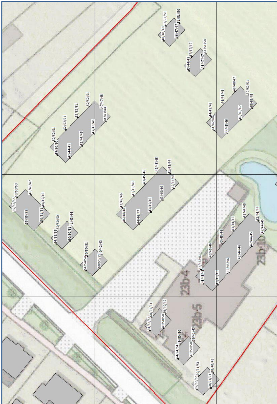
Afbeelding 7.2 Geluidbelastingen L_{den} (excl. aftrek art. 110g Wgh) Cumulatief Berekende geluidbelastingen op een hoogte van 1,5 / 4,5 / 7,5 meter
