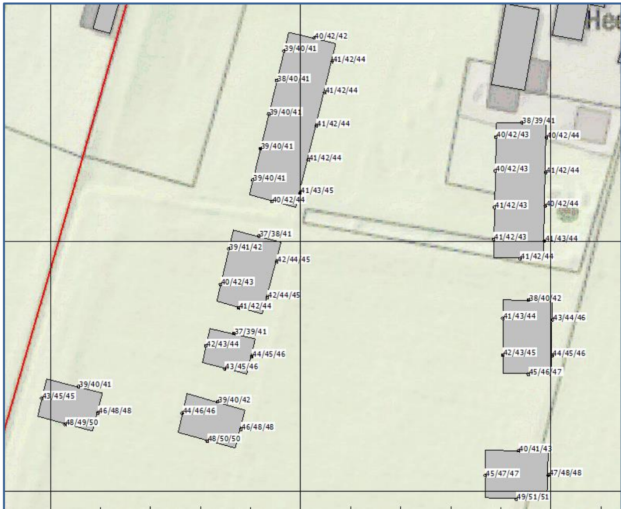
Afbeelding 7.4 Geluidbelastingen L_{den} (excl. aftrek art. 110g Wgh) Cumulatief Berekende geluidbelastingen op een hoogte van 1,5 / 4,5 / 7,5 meter
