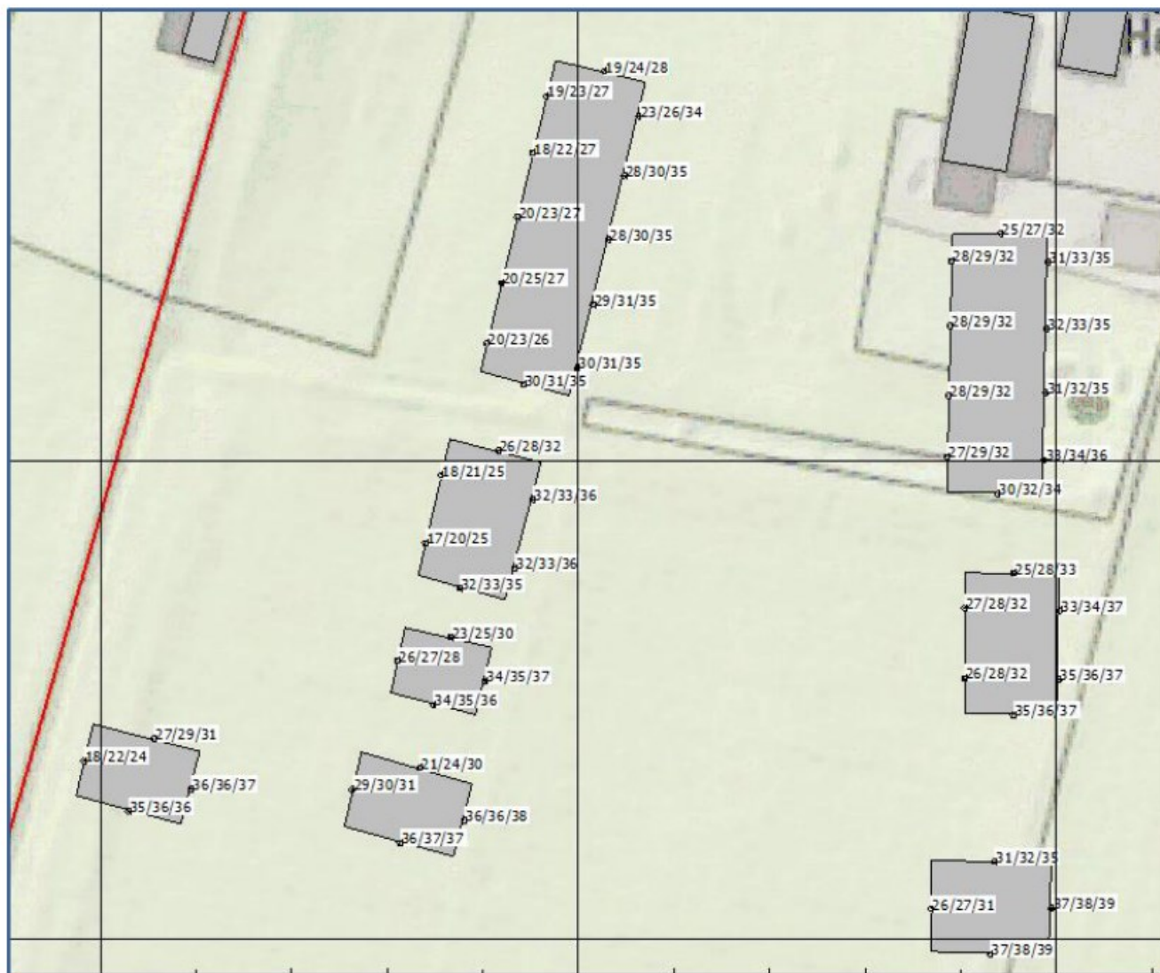
Afbeelding 6.4 Geluidbelastingen L_{den} (incl. aftrek art. 110g Wgh) N273 Berekende geluidbelastingen op een hoogte van 1,5 / 4,5 / 7,5 meter
