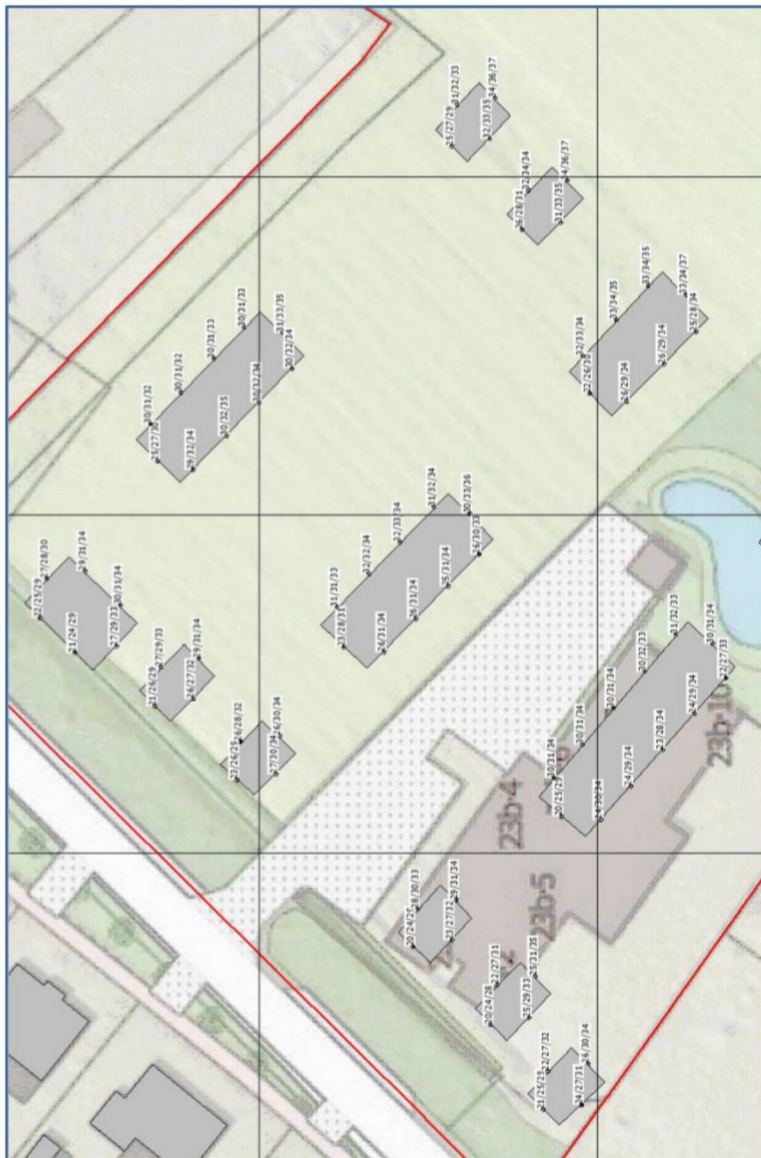
Afbeelding 6.2 Geluidbelastingen L_{den} (incl. aftrek art. 110g Wgh) N273 Berekende geluidbelastingen op een hoogte van 1,5 / 4,5 / 7,5 meter
