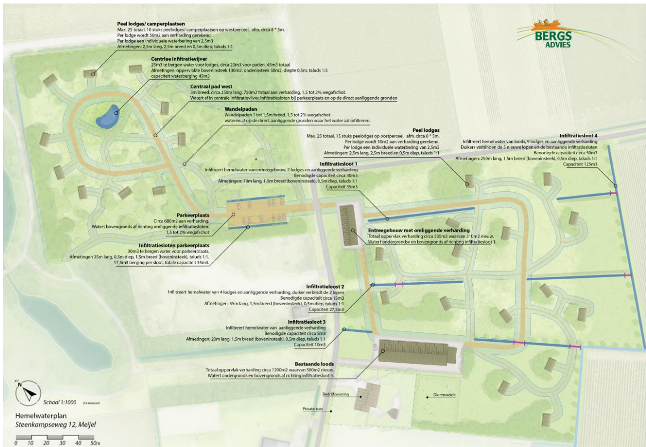
Figuur 4.9.1: Inrichting waterberging Steenkampseweg 12 (Bergs Advies BV, 2023)
