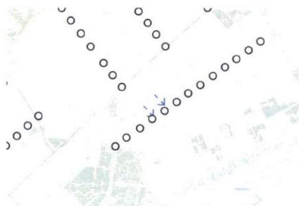
Turbineopstelling behoudt afstand tot de weg
